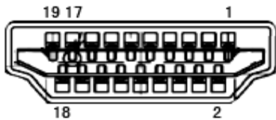
Câble de signal d'affichage couleur à 19 broches
