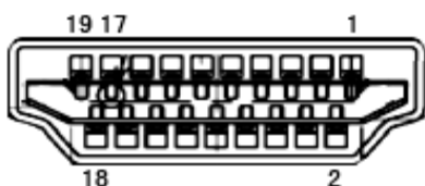
19-ben kabel til farveskærme
