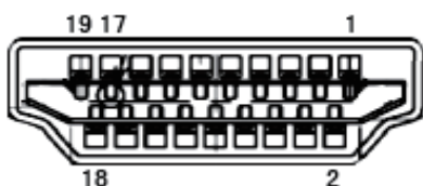
19-контактный кабель для передачи сигналов цветного изображения
