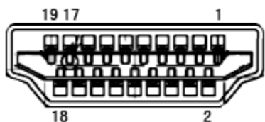
19-контактный кабель для передачи сигналов цветного изображения
