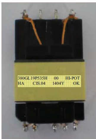
次级绕组TAPE适当加宽为6.0mmMIN，使得TAPE向三层线方向偏移约TAPE宽度的1/4~1/5贴到三层线上 初级线圈与三层线交叉处不接触
