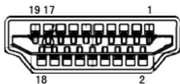
Καλώδιο σήματος έγχρωμης οθόνης 19 ακίδων
